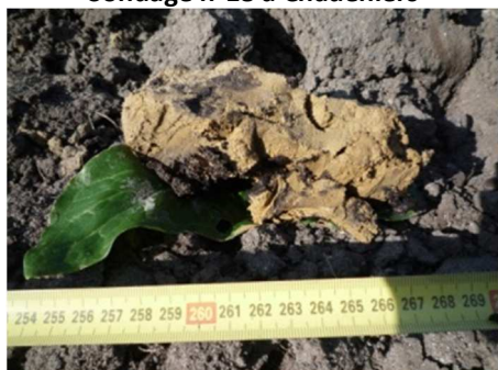
Photographie 4-5 : Prélèvements d'argile et de tourbe lors de la campagne de sondages
