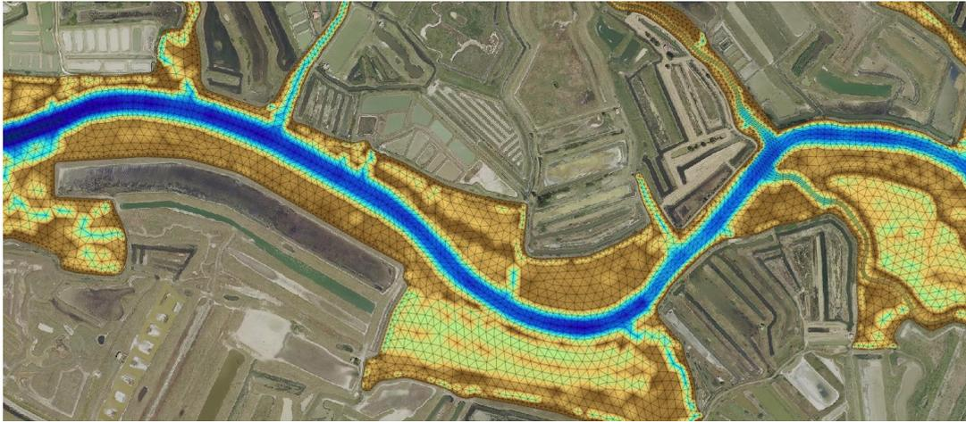
Figure 12 : Bathymétrie théorique interpolée sur le maillage dans le canal de Pélard.
